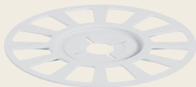
Zur Kombination mit Tellerdübeln ( $\varnothing$ -Teller: 60 mm). Zur Vergrößerung des Tellerdurchmessers von WDVS-Dübeln. Speziell für die oberflächenbündige Montage in Mineralwolle-Lamellendämmplatten. Hohe Tellersteifigkeit für problemlose Montage. Hohe Traglasten dank zusätzlicher Putzverkrallung. In Kombination mit ejotherm STR U 2G, ejotherm STR U oder ejotherm STR H sind die speziellen ejotherm STR-Stopfen zu montieren.
