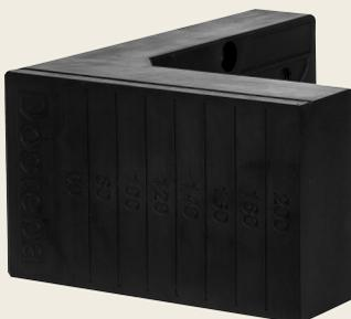
Tragwinkel TRA WIK® PU eignen sich für wärmebrückenfreie Fremdmontagen in Wärmedämmverbundsystemen, hinterlüfteten Fassaden, Innendämmungen usw. Tragwinkel TRA WIK® PU bestehen aus schwarz eingefärbtem, fäulnisbeständigem und FCKW-freiem PU-Hartschaum (Polyurethan) mit drei eingeschäumten Unterlegscheiben.
