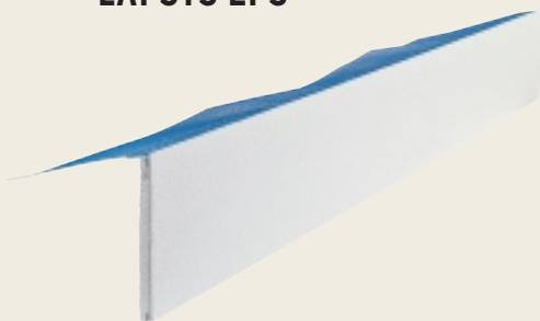
Das Laibungssystem LAI SYS EPS besteht aus einem Laibungselement sowie einem Anschlussprofil. Laibungselemente LAI SYS EPS bestehen aus EPS 20 kg/m<sup>3</sup>, mit einem eingeklebten Kombiwinkel und Gewebe sowie einer Beschichtung auf der Laibungsfläche. Dicke: 14 mm
