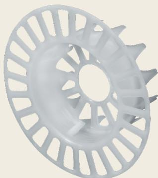
Speziell abgestimmter Kombiteller für ejotherm STR U 2G zur vertieften Montage in allen Mineralwolle-Dämmplatten WAP-zg (Typ WV). Ermöglicht die vertiefte Montage nach EJOT STR-Prinzip nun auch in Mineralwolle-Dämmplatten mit geringer Quersugsfestigkeit WAP-zg (Typ WV), für homogene und glatte Oberflächen, mit Europäischer Technischer Zulassung (ETA).
