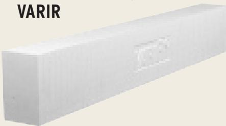
Montagequader VARIR® eignen sich für wärmebrückenfreie Fremdmontagen in Wärmedämmverbundsystemen aus expandiertem Polystyrol (EPS) und Steinwolle (SW). Zudem eignen sie sich als Druckunterlage für mittelschwere Lasten. Montagequader VARIR® sind formgeschäumte Quader aus EPS mit hohem Raumgewicht. Der umlaufende 20 mm Raster gibt den genauen Sägeschnitt vor.
