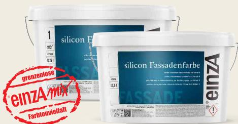
Für wasserabweisende (hydrophobierende), hoch wasserdampfdurchlässige Außenanstriche auf ungestrichenen, mineralischen Untergründen. Für Renovierungsanstriche auf tragfähigen Silicon- oder Silikatfarben und matten Dispersionsfarbanstrichen. Alkalibeständig, schmutzabweisend und alterungsbeständig. Mit Formel H. **Farbe:** weiß
