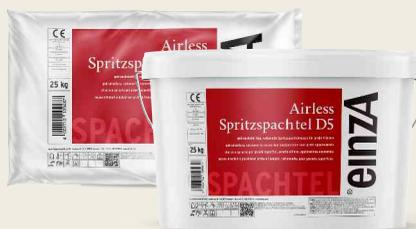
Fertiggemischte, bindemittelstarke Spritzspachtelmasse. Mineralischer Flächenspachtel für Wände und Decken innen, auf Gipskarton, Fermacell-Gipsfaserplatten, Putz, Beton und Kalksandstein. Nicht für Feuchträume geeignet. Sehr leicht zu verarbeiten. Durch normales Spritzen ist eine Raufaserstruktur erreichbar. Ein Überstreichen ist an Deckenflächen nicht unbedingt erforderlich. Es kann mit jeder Dispersionsfarbe überstrichen werden, enthält ca. 95 % natürliche Rohstoffe. **Farbe:** weiß
