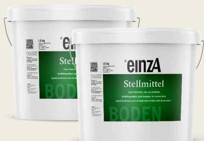
Faserförmiges Stellmittel mit guter, staubloser Einarbeitbarkeit. Gut geeignet für Mörtelmassen. Für die Verbesserung der Standfestigkeit bei geneigten Flächen. Reduziert den Selbstverlauf und verhindert ein Abfließen bei Rampen und geneigten Flächen bei einer Neigung von 3–20 %. **Farbe:** weiß
