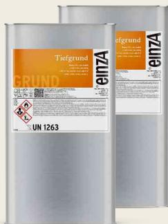
Aromatenfreies Grundierungsmittel, lösungsmittelhaltig, farblos, verdünnbar mit einZA Lackverdünnung AF. Für die Tiefgrundierung von mineralischen Untergründen wie z. B. Putz, Beton, Mauerwerk. Alkalibeständig; alterungsbeständig; wasserdampfdurchlässig; nur gering quellbar; tief eindringend; keine anlösende Wirkung. Lange Offenzeit, mit verdunstungshemmender Wirkung auf frischen Mörtelmassen. **Farbe:** farblos
