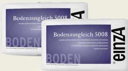
Diese zementäre Spachtel- und Nivelliermasse dient im Innenbereich zum Spachteln, Ausgleichen und Nivellieren von Estrichen, Schnellestrichen und Rohbetondecken. Ein Einsatz als Dünnestrich und Verbundausgleich auf Rohbetondecken und -sohlen ist ebenfalls möglich. Bei zu erwartenden Schichtdicken von 10-20 mm muss die Masse mit Sand der Körnung 0 bis 4 mm gestreckt werden. Für Parkettverlegungen und auf Gussasphaltestrichen für Schichtdicken von 2 bis max. 5 mm geeignet. **Farbe:** grau
