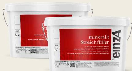
Streichfertiger, gut füllender Zwischenanstrich auf Silikatbasis für griffige, feinkörnige Oberflächen im Innen- und Außenbereich; wasserabweisend, hoch dampfdurchlässig; für raue, grobkörnige mineralische Untergründe. einA mineralit-Streichfüller ist spannungsarm und trocknet auch in dickeren Schichten rissfrei auf. Ohne Zusätze von Konservierungsmitteln, besonders geeignet für sensible Bereiche. **Farbe:** weiß
