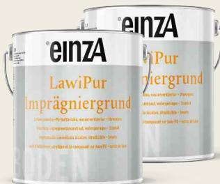
Wasserverdünnbares Konzentrat einer haftvermittelnden 2-Komponenten-PU-Grundierung für außen und innen mit Wasser als Härter-Komponente; tief eindringende, verfestigende Systemgrundierung für Beschichtungen mit einZA LawiPur BW. **Farbe:** farblos
